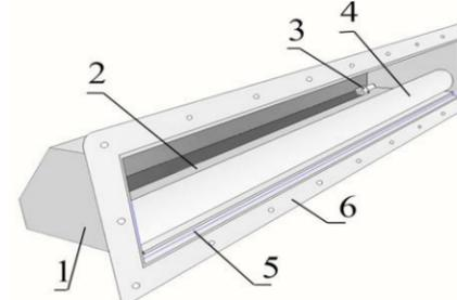
КСИД состоит из корпуса 1 и затвора 2, на котором методом сварки укреплен груз 4 (в модификации «Т» груз крепится с помощью винтов).
